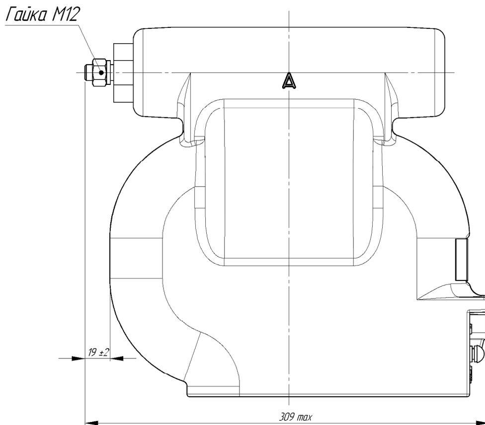
Рисунок Б.2 Внешний вид трансформаторов ЗНОЛПМИ
