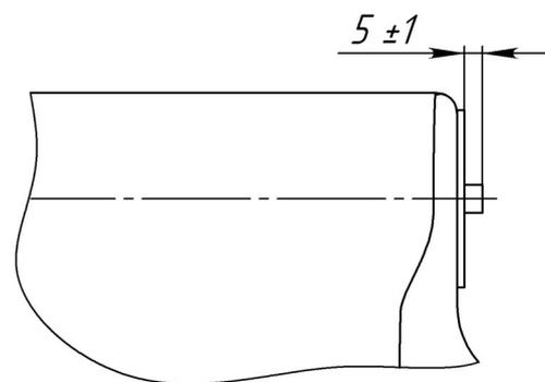
Рисунок В.7 Защитное предохранительное устройство сработало
