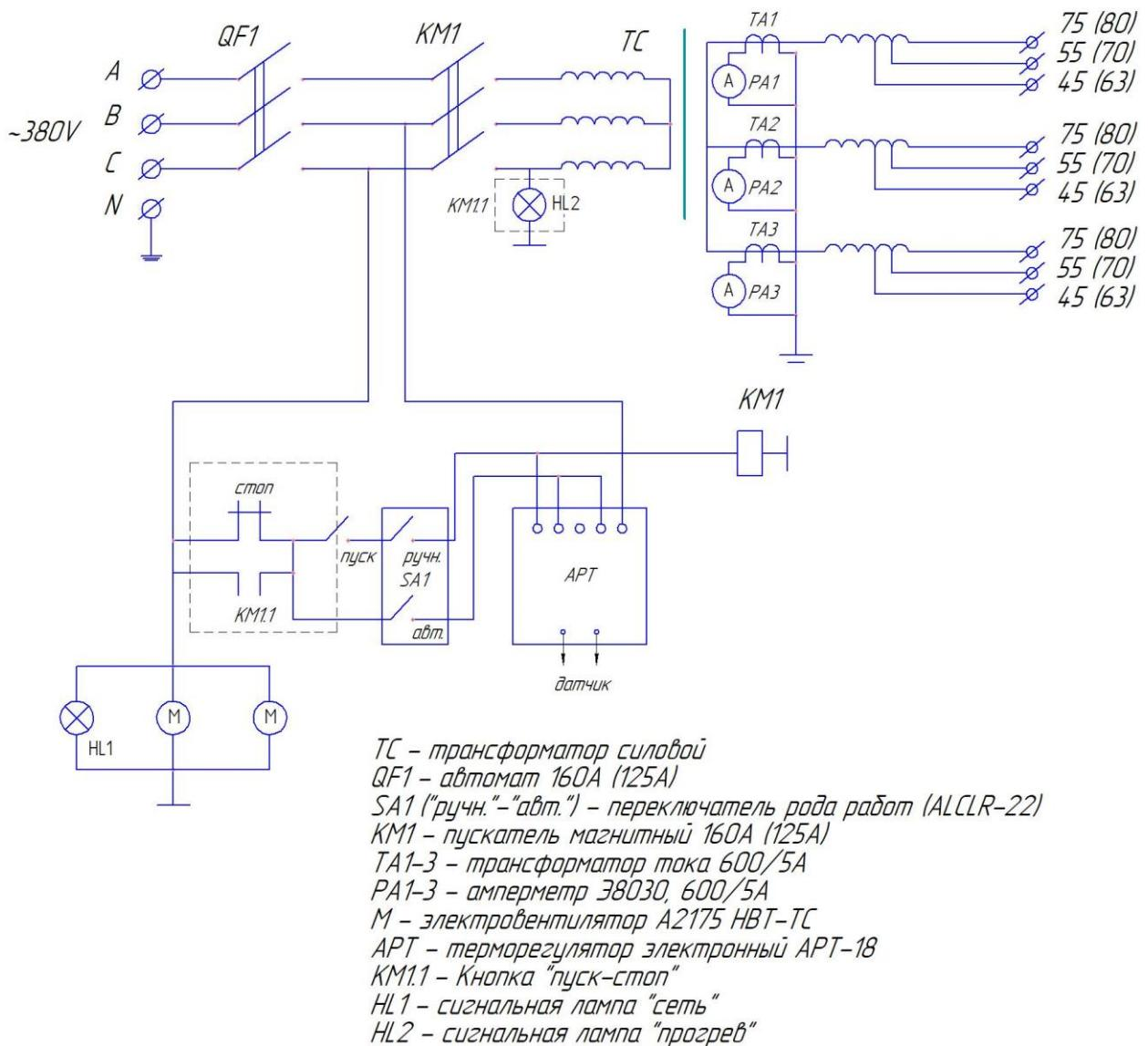
Схема электрическая принципиальная ТСДЗ-80А(63А).
