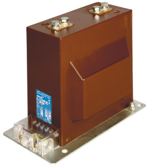
Трансформатор тока ТЛК-СТ-20 опорный предназначен для передачи сигнала измерительной информации измерительным приборам и устройствам защиты и управления, для изолирования цепей вторичных соединений от высокого напряжения в комплектных электрических устройствах внутренней установки (КРУ, КРУН, КСО) переменного тока на класс напряжения 20 кВ.
