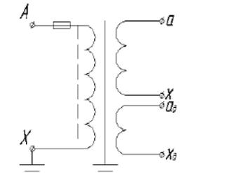
Рисунок А.3 Принципиальная электрическая схема трансформаторов ЗНОЛП
