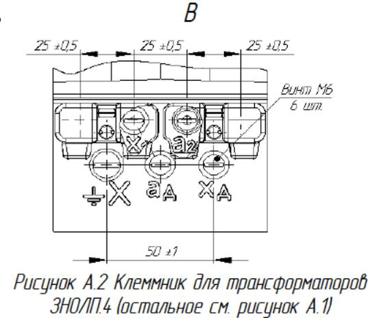
Рисунок А.2 Клеммник для трансформаторов ЗНОЛП4 (остальное см. рисунок А.1)
