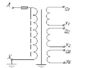
Рисунок А.4 Принципиальная электрическая схема для исполнения ЗНОЛП4
