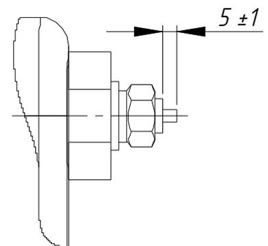
Рисунок В.3 Защитное предохранительное устройство сработало
