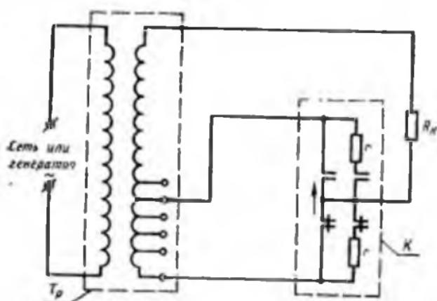
$R_H$  — нагрузочный резистор;  $T_p$  — испытательный трансформатор или автотрансформатор;  $K$  — контактор (переключатель нагрузки) с токоограничивающим резистором.
