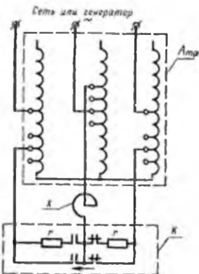
Ато — испытательный автотрансформатор или трансформатор;  $X$  — нагрузочный ре-актор;  $K$  — контактор (переключатель на-грузки) с товами различающими ре-зисто-рами.
