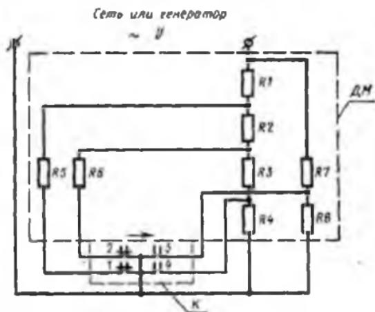
ДМ — делитель мощности из резисторов; К — контактор (переключатель нагрузки).
