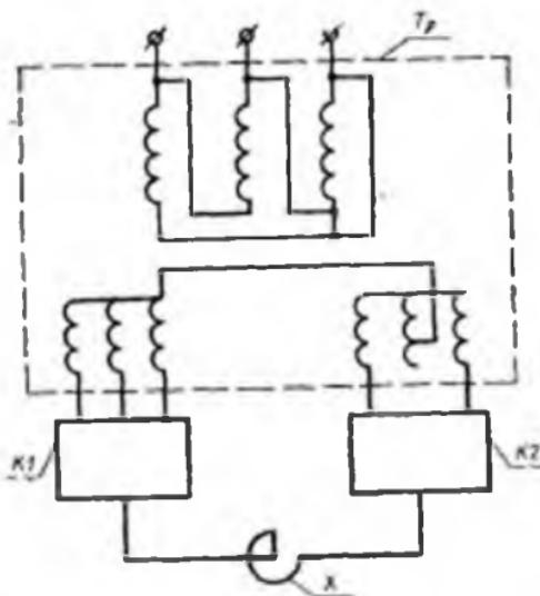
$T_p$  — испытательный трансформатор или автотрансформатор;  $K_1$ ,  $K_2$  — фазы контактора (переключателя нагрузки);  $X$  — нагрузочный реактор.
