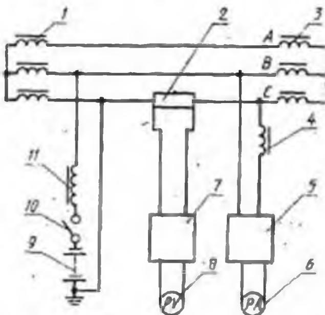
1 — питающий трансформатор; 2 — шунт; 3 — измеренная обмотка; 4 — индуктивность; 5 — фильтр; 6 — микроамперметр; 7 — фильтр; 8 — милливольтметр; 9 — аккумуляторная батарея; 10 — выключатель; 11 — дроссель
