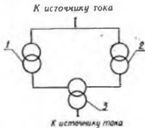
1 — испытуемый трансформатор; 2 — вспомогательный трансформатор;
