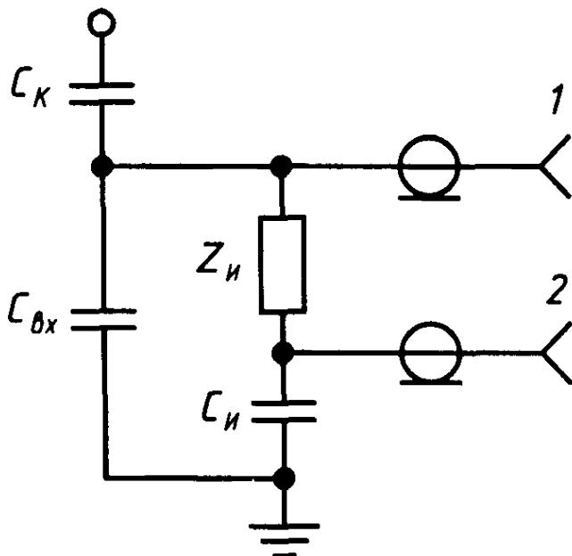
$C_k$  — емкость ввода или соединительного конденсатора;  $C_{bx}$  — емкость на входе измерительного устройства (суммарная емкость измерительной обкладки ввода и измерительного кабеля);  $Z_u$  — сопротивление измерительного элемента;  $C_u$  — емкость измерительного конденсатора; 1 — разъем для присоединения устройства измерений характеристик частичных разрядов; 2 — разъем для присоединения приборов, измеряющих испытательное напряжение
