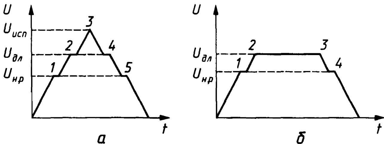
$U_{исп}$  — нормированное испытательное одноминутное напряжение;  $U_{дл}$  — нормированное испытательное длительное напряжение,  $U_{нр}$  — наибольшее рабочее напряжение
