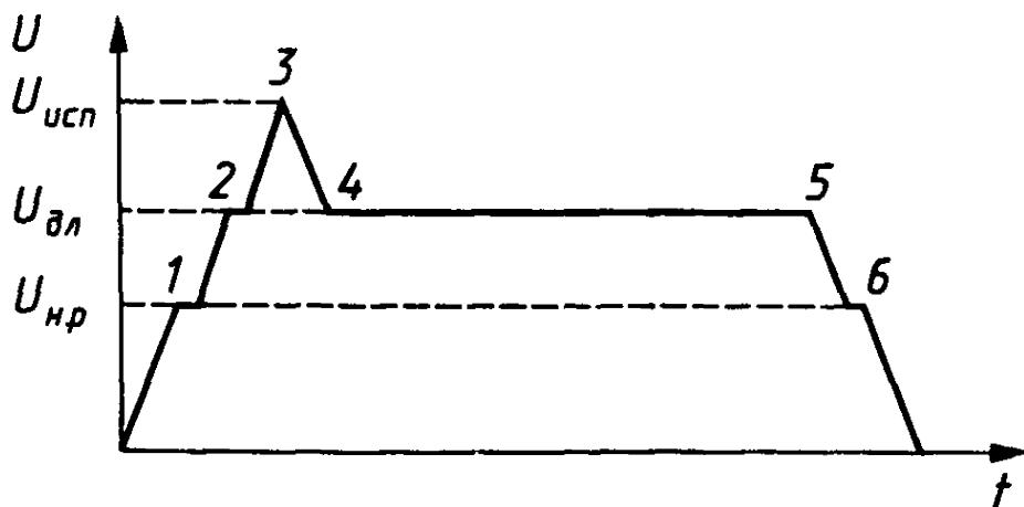
$U_{исп}$  — нормированное испытательное одноминутное напряжение,  $U_{дл}$  — нормированное испытательное длительное напряжение;  $U_{нр}$  — наибольшее рабочее напряжение
