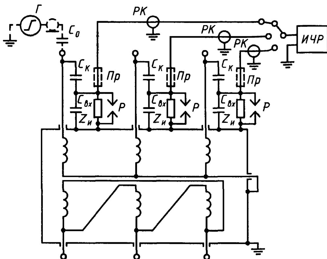
*IChP* — измерительный прибор (или комплект измерительных приборов);  $Z_n$  — сопротивление измерительного элемента;  $PK$  — измерительный кабель;  $C_k$  — емкость ввода или отдельного соединительного конденсатора;  $C_{bx}$  — емкость на входе измерительного устройства (суммарная емкость измерительной обкладки ввода и измерительного кабеля);  $C_0$  — емкость градуировочного конденсатора;  $G$  — градуировочный генератор;  $P$  — защитное устройство;  $P_p$  — предохранитель
