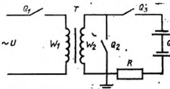
$Q_1, Q_2, Q_3$  — выключатели;  $T$  — испытуемый трансформатор;
