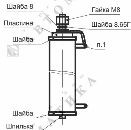
Рисунок Б.2 Монтажная схема соединения резисторов
