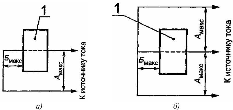
1 — испытуемый трансформатор;  $A_{\max}$  — расстояние между осями проводников соседних фаз в месте установки трансформатора в эксплуатации;  $B_{\max}$  — расстояние в свету от трансформатора до места ближайшего изгиба проводника, служащего в эксплуатации первичной обмоткой трансформатора
